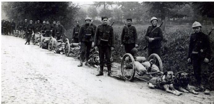
Ces voiturettes sont créées par le lieutenant Blangarin ainsi que celles destinées au transport des munitions et d'accessoires. Cette innovation qui adapte en fait une coutume civile typiquement belge permet le déploiement de la mitrailleuse rapidement et dans des terrains que d'autres animaux ne peuvent pas atteindre.
