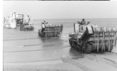
Tanks Churchill ARK pour franchir un mur et Sherman Crab, GB, 1944, © IWM, London
